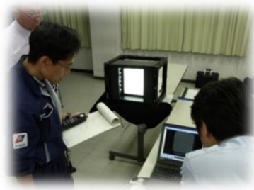
撮像部の光源ムラ測定風景
