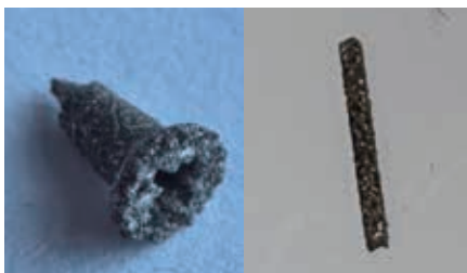
図2:3Dプリンティングで作成したチタン合金の直径3.0mmのネジ(左)とアモルファス合金の0.5mm角ワイヤー(右)
