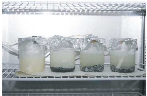
図1 5℃における浄化試験
