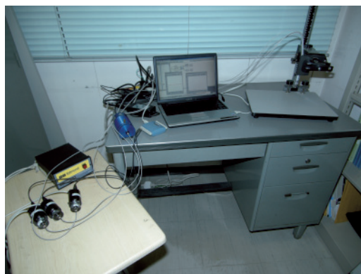
図7. フィルタ+フォトダイオードによる身色計測検討
