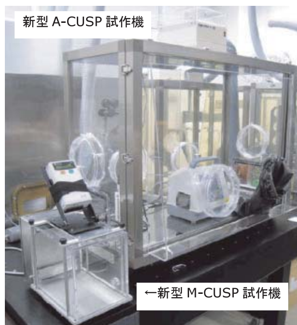
図1 モニター可能型 M-CUSP 並びに、M-CUSP-S-CUSP 間で試料出し入れを可能とする差アクリル製 A-CUSP
