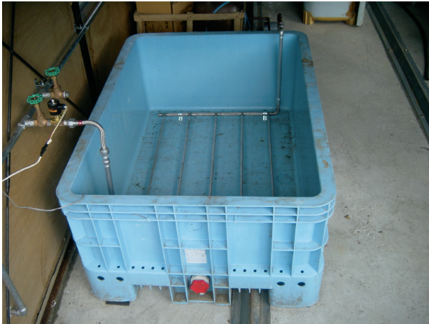
写真 1 砂を入れる前の発酵層
