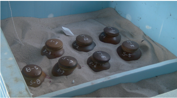
写真 2 発酵層に設置された壺の状態
