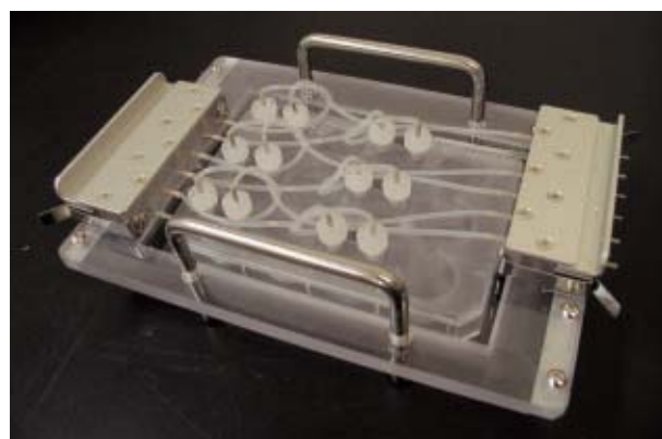
図1 化学物質評価用培養チャンバーの外観
